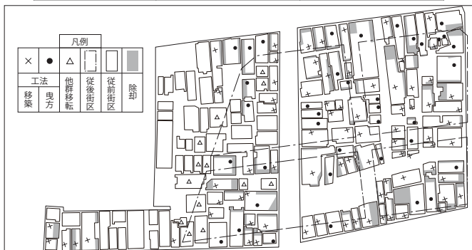
図3 建物移転工法と除却面積の作図の一部分（第8地区第25、26移転群）
